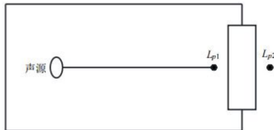
图4-2 室内声源等效为室外声源示意图
