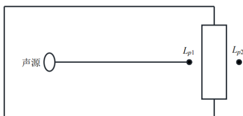
图 4-1 室内声源等效为室外声源图例
