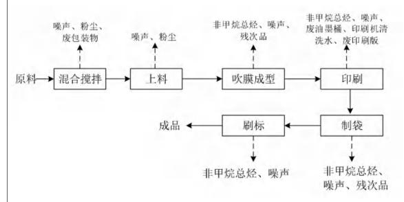
图3 塑料袋生产工艺及产污节点图
