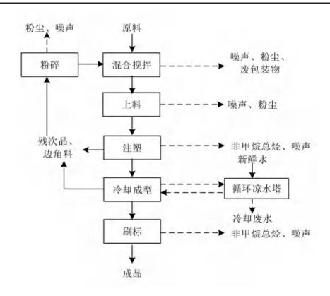
图2 塑料衣架、塑料碗、塑料壶工艺流程及产污环节示意图
