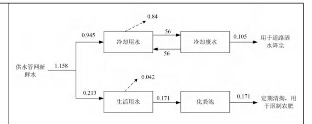
图1 本项目水平衡图(单位: m³/d)
