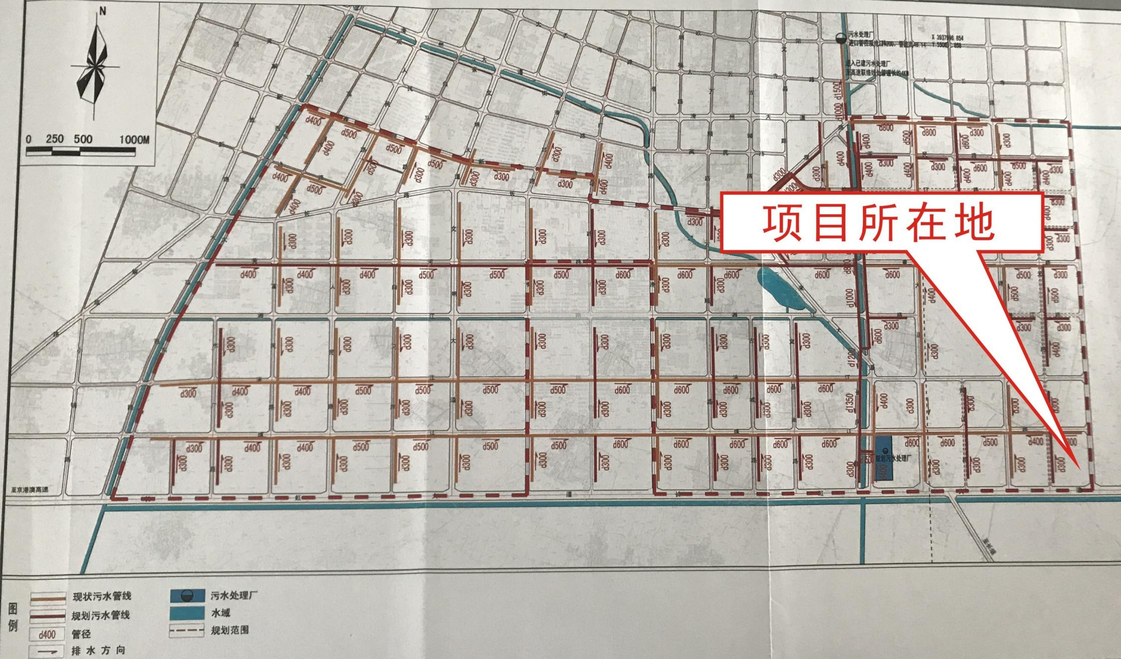
附图7 滑县产业集聚区污水工程规划图
