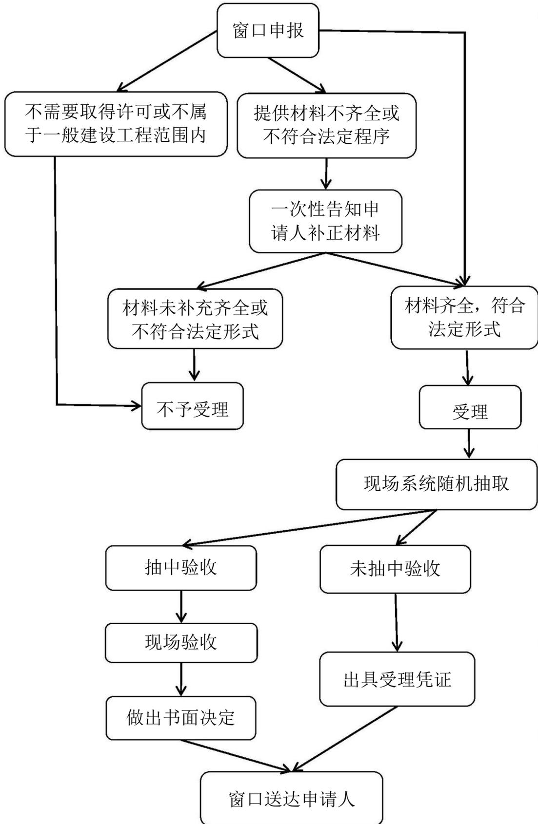
房屋建筑和市政基础设施工程竣工验收备案流程图
